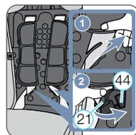
9. Удалите язычки замка 21 из предусмотренного для них отверстия 44 на нижней части спинки.
