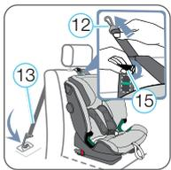
2.4. Возьмите ремень Top Tether (13) и отодвиньте металлический язычок (15), чтобы его удлинить. Затем протяните ремень Top Tether (13) с помощью крючка (12) так, чтобы он принял V-образную форму.
